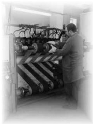
Rezanie z výrobnéj šírky na štandardné rozmery
