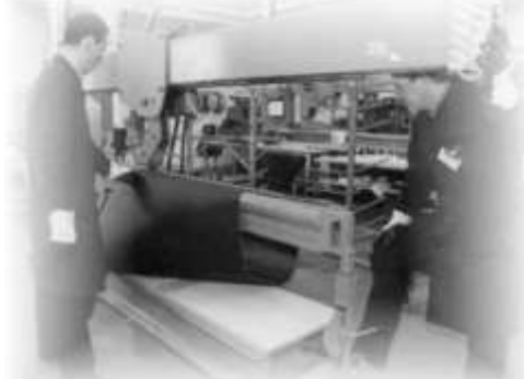
Lisovanie spoja širokých brúsnych pásov
