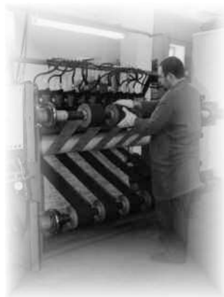
Rezanie z výrobovej šírky na štandardné rozmery
